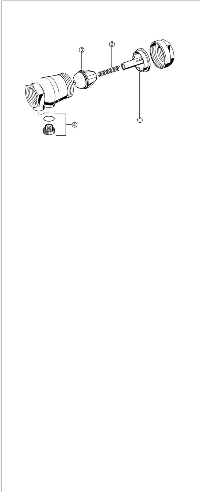
**Запчасти для обратных клапанов RV 280
